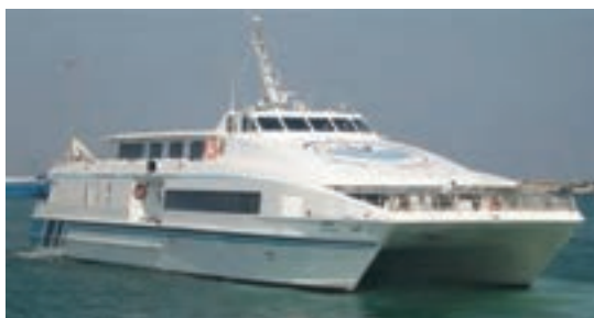
شکل ۱۵- یک شناور کاتاماران با بدنه آلومینیومی
