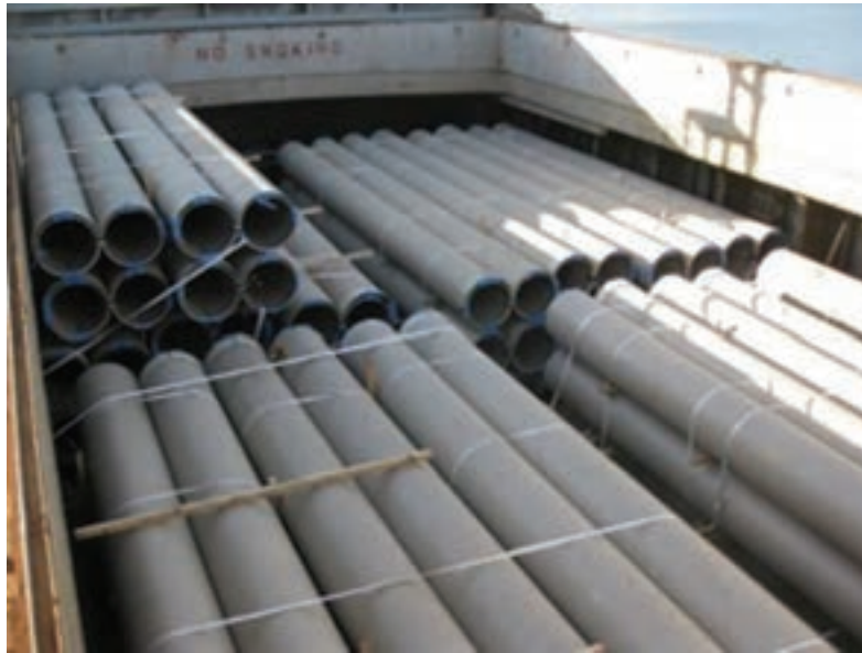
شکل ۱- بارچینی و مهار کالا در انبار یک کشتی
