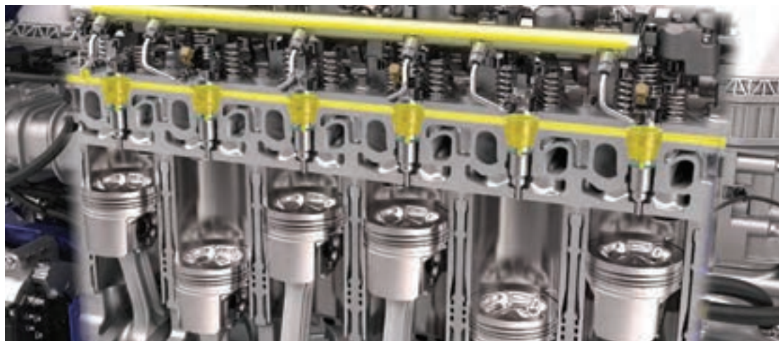
شکل ۲۰- سامانه تزریق سوخت
